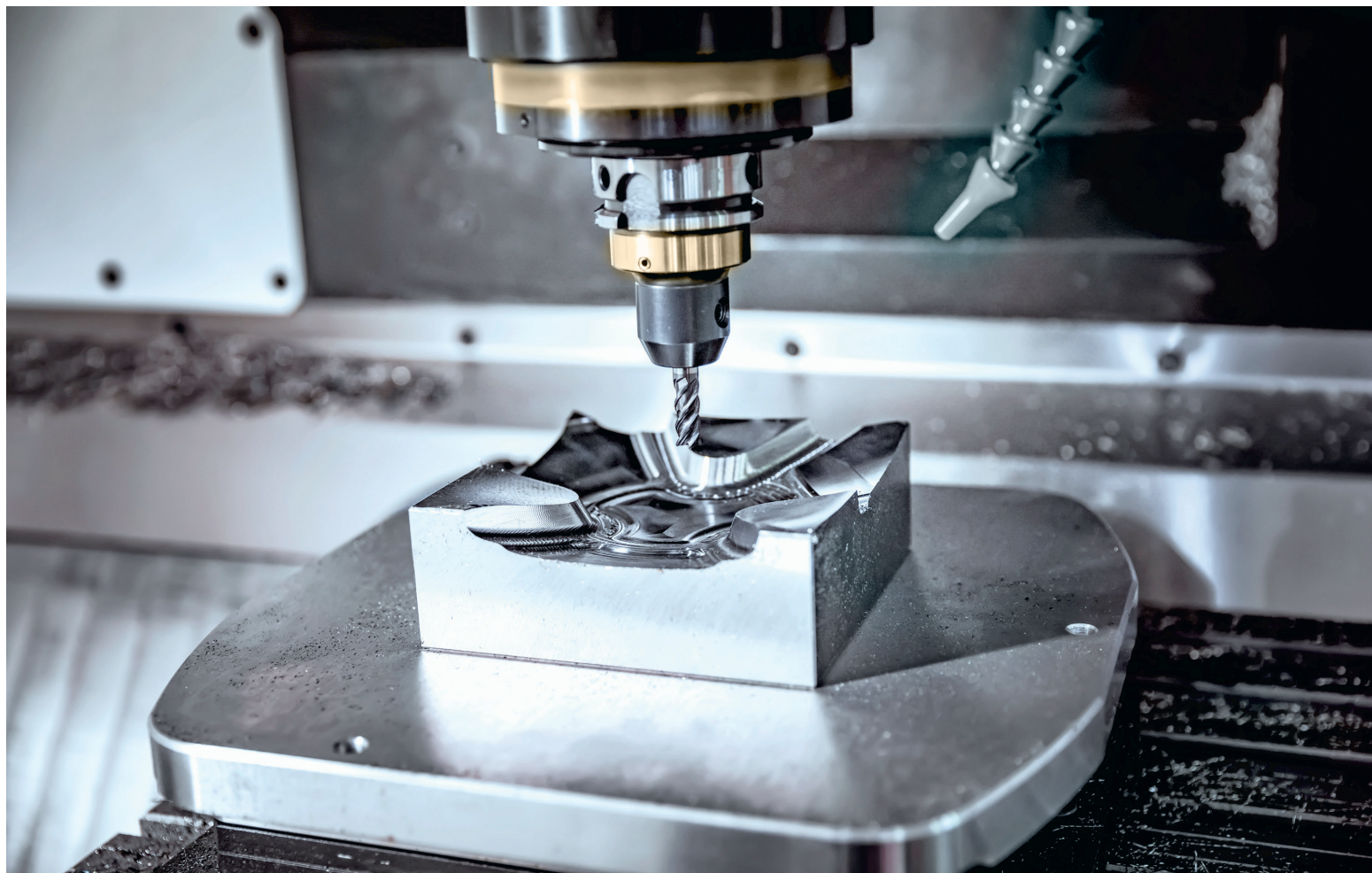
IGS GeboJagama produceert matrijzen voor de medische industrie. Deze moeten voldoen aan extreem hoge eisen op het gebied van maat- en oppervlaktetoleranties
