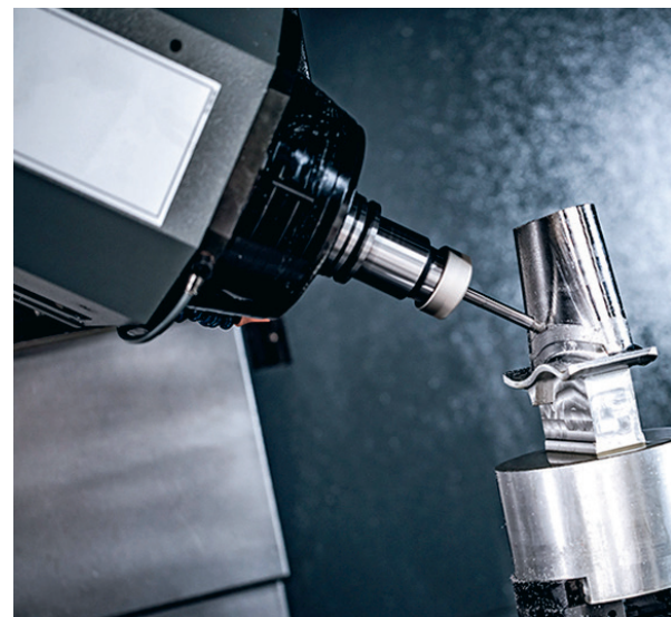
IGS GeboJagama zet de vijfassige Makino D200Z in voor de precisiebewerking van complexe 3D-geometrieën.
